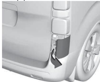
1. Автомобили с крышкой, закрывающей винт блока нижнего заднего фонаря: снимите крышку, аккуратно отжав фиксаторы отверткой, и немного наклонив крышку кнаружи.
