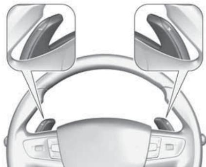
На автомобилях с автоматической КПП переключением передач можно управлять при помощи лепестков + и -.
