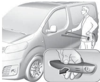
Электронный ключ должен находиться вне автомобиля, на расстоянии приблизительно до одного метра от соответствующей двери.
