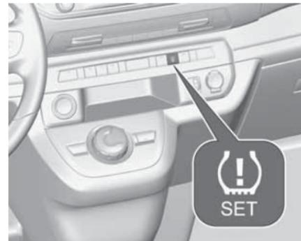
а) Автомобили без информационно-развлекательной системы: Нажмите кнопку (!) на 3 секунды. Начало процедуры подтверждается звуковым сигналом.
