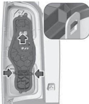
7. Отсоедините центральный фиксатор, потяните за держатель лампы и высвободите остальные фиксаторы.
