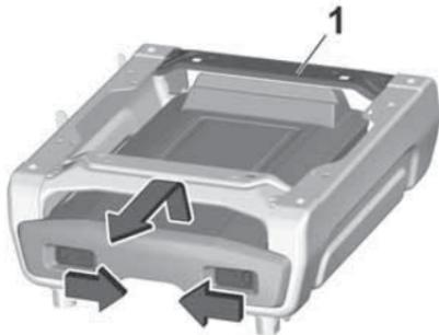
2. Чтобы освободить ящик, нажмите на защелки и сдвиньте их внутрь. Немного приподнимите ящик, чтобы освободить его от поперечины 1. Вытяните ящик.
