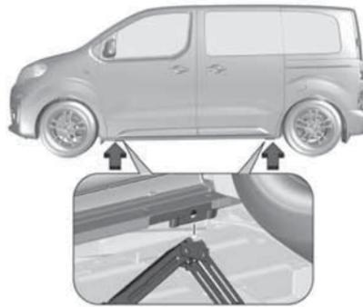
3. Убедиться, что домкрат надлежащим образом установлен под соответствующей подъемной точкой на автомобиле. Поставить его непосредственно под точкой для поддомкрачивания так, чтобы он не выскользнул.
