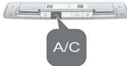
Нажмите клавишу **A/C**, чтобы включить режим охлаждения. Охлаждение работает только при включенном двигателе и включенном вентиляторе климат-контроля.
