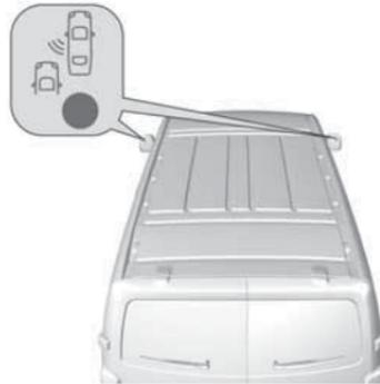
Если во время движения передним ходом система обнаружит автомобиль в боковой мертвой зоне, в наружном зеркале заднего вида с соответствующей стороны загорится светодиод.
