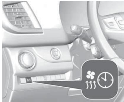
Текущее состояние автономного отопителя указывается светодиодным индикатором.
