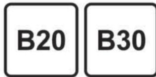
Допускается использовать топливо B20 или B30, соответствующее стандарту EN16709. В то же время
