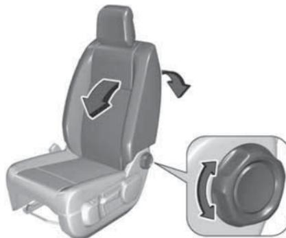
Регулировка угла наклона спинки сиденья осуществляется вращением рукоятки. Во время регулировки не облакачивайтесь на спинку.
