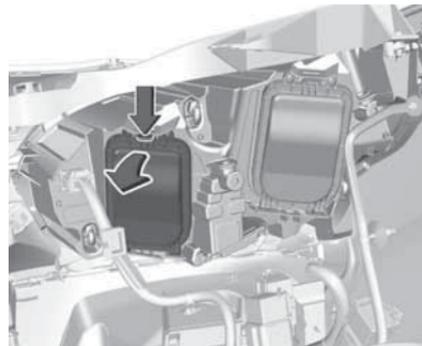
1. Снимите защитную крышку.
