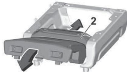
1. Вставьте ящик, держа его наклонно передней стороной кверху. Проведите ящик мимо поперечины 2, нажимая на него внутрь и вниз.
