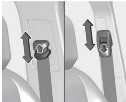
Нажмите на кнопку фиксатора и переместите регулятор высоты вверх или вниз в нужное положение.
