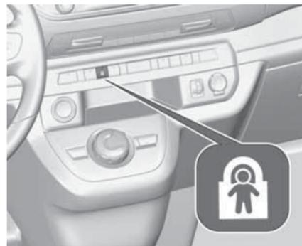
Дистанционно управляемая система, предотвращающая открытие сдвижных дверей дверными ручками в салоне.
