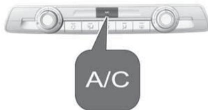
Нажмите клавишу **A/C**, чтобы включить режим охлаждения. В кнопке загорается светодиод, указывая, что система работает. Охлаждение работает только при включенном двигателе и вентиляторе.
