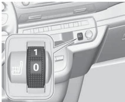
Подогрев сидений включается колесиком
