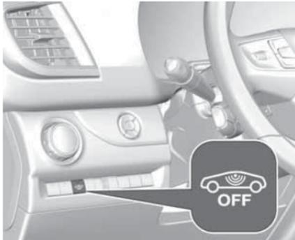
Следует отключить контроль салона, если в нем осталось животное, так как вредные для него ультразвуковые сигналы имеют высокую мощность, а движение животного может привести к срабатыванию противоугонной сигнализации. Систему также следует выключить при перевозке автомобиля на пароме или железнодорожным транспортом.
