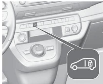
На некоторых модификациях замок подъемной задней двери грузового отделения можно отпереть изнутри, нажав кнопку
