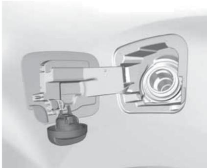
Крышку топливозаправочной горловины можно повесить на крючок с внутренней стороны люка. Установите пистолет вдоль оси топливозаправочной горловины и слегка нажмите, чтобы вставить его в бак.
