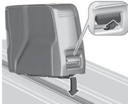
Ручкак спереди должна быть в зафиксированном положении. Установите заднюю часть многофункционального столика на направляющую и опустите переднюю часть. Сдвиньте многофункциональный столик до фиксации.
