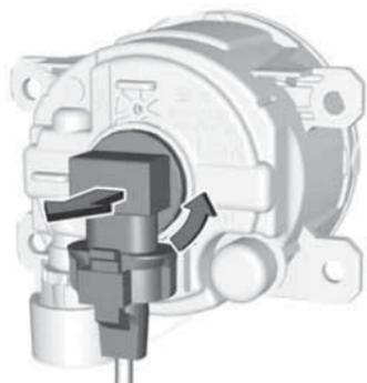
2. Поверните патрон лампы против часовой стрелки, чтобы извлечь его из фары.
