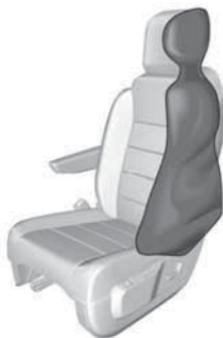
Надутые воздушные подушки безопасности амортизируют удар, тем самым они снижают опасность травмирования верхней части туловища и таза в случае серьезного бокового удара.
