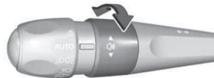
Для включения/выключения заднего противотуманного фонаря поверните колесико управления один раз.
