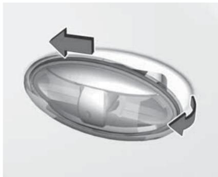
1. Сдвиньте корпус фары вперед и отсоедините ее сзади. Для отсоединения корпуса блок-фары от кузова можно воспользоваться отверткой. Оберните конец отвертки тканью, чтобы не повредить краску.
