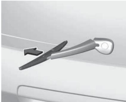
Поднимите рычаг стеклоочистителя. Отсоедините щетку стеклоочистителя, как показано на рисунке, и снимите ее.
