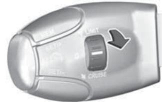
Поверните переключатель в положение **Cruise**; на дисплее информационного центра водителя отобразится индикатор
