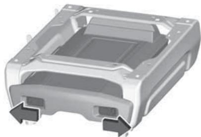
2. После того как ящик войдет в нишу, опустите его и сдвиньте защелки наружу, чтобы зафиксировать его.
