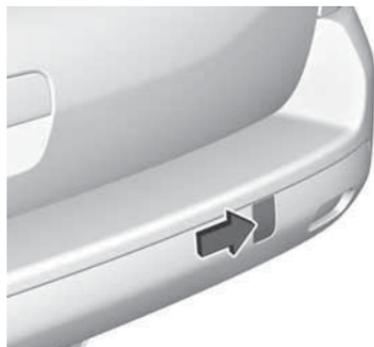
Чтобы отсоединить крышку на заднем бампере, нажмите на ее верхний левый угол.
