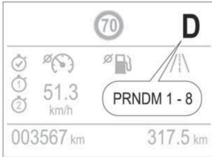
На дисплей информационного центра водителя выводится режим ее работы и выбранная передача.
