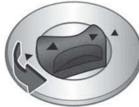
3. Поверните фиксаторы против часовой стрелки на четверть оборота.
