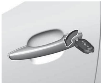
Откройте дверь водителя вручную, вставив ключ в замок и повернув его.
