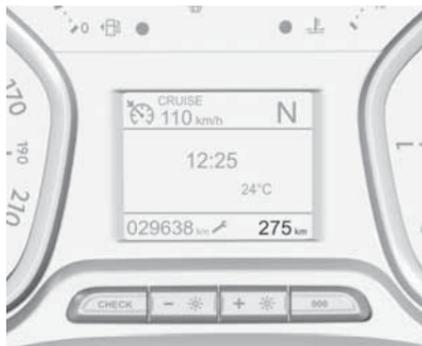
Счетчик текущего пробега имеет предельное значение 1999,9 км и после этого автоматически сбрасывается.
