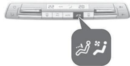
Чтобы включить подачу охлажденного/теплого воздуха через задние сопла вентиляции, нажмите
