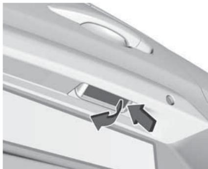
Вставьте, например, тонкую отвертку в один из вырезов крышки и отсоедините крышку, пользуясь отверткой как рычагом. Снимите крышку.
