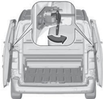
Двери фиксируются в открытом положении под углом 90° с помощью рычагов-фиксаторов. Чтобы открыть двери на 180°, нажмите на защелку и распахните дверь в требуемое положение. Прежде чем закрывать двери, проследите, чтобы запор находился в положении 90°.
