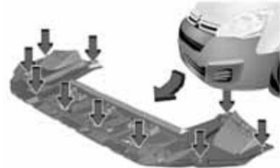
1. Отвинтите и снимите крышку защиты дна.
