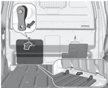
Поверните замок вверх. Вставьте лючок в петли и закройте его, зафиксировав замком.
