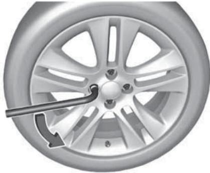
2. Баллонным ключом отверните каждый из колесных болтов на полоборота.
