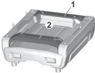
1. Ящик фиксируется двумя поперечинами, которые не дают ему выскользнуть из ниши, если он установлен неправильно.
