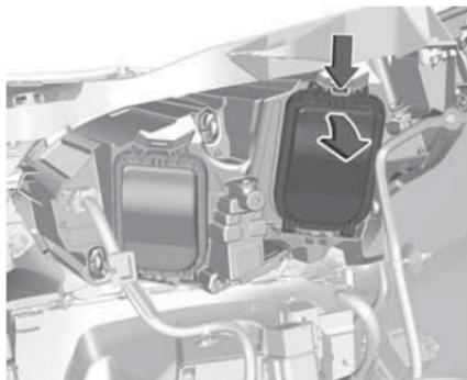
1. Снимите защитную крышку.
