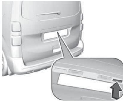
Если электронный ключ находится снаружи автомобиля, но не далее примерно 1 метра от подъемной задней двери, нажмите правую кнопку на подъемной задней двери грузового отделения, чтобы отпереть замки.
