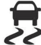
После пуска двигателя системы контроля тягового усилия и динамической стабилизации будут готовы к работе, как только погаснет индикатор
