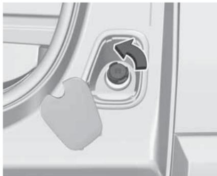
4. Скрутите предохранительную пробку с заправочной горловины.
