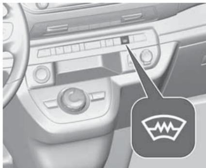
Чтобы включить подогрев, нажмите клавишу
