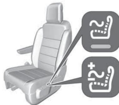
Функция массажа спины включается нажатием
