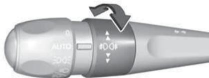
Для включения/выключения заднего противотуманного фонаря поверните колесико управления два раза.
