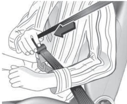
Вытянуть ремень безопасности из подматывающего механизма, не перекручивая направить его поперек туловища и вставить язычок защелки ремня безопасности в пряжку. Во время движения автомобиля следует регулярно подтягивать поясную часть ремня, вытягивая ремень за плечевую часть.
