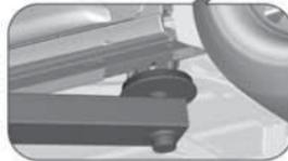
Место установки задней лапы подъемника — по центру в предусмотренном для этого месте на кузове.
