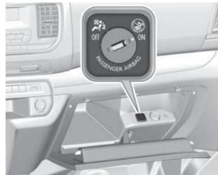
Фронтальная подушка безопасности переднего пассажира отключается с помощью выключателя, расположенного на панели приборов со стороны пассажира.
