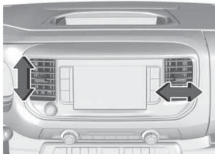
Наклоняя и поворачивая решетку, установите требуемое направление потока воздуха.
