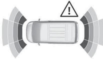
Кроме того, расстояние до находящегося сзади или спереди препятствия отображается на дисплее информационного центра водителя ↗ 135 с помощью цветных сегментов.
