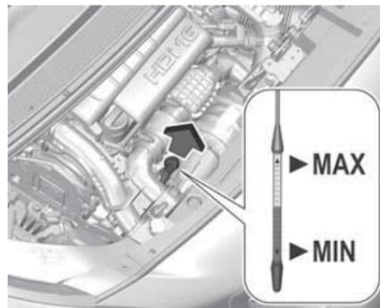
Выньте щуп, протрите его, вставьте до упора, затем снова выньте и проверьте уровень масла.
