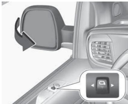
Потяните клавишу складывания наружных зеркал
