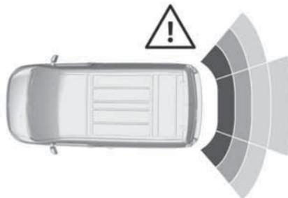
Кроме того, расстояние до находящегося сзади препятствия отображается на дисплее информационного центра водителя ↻ 135 с помощью цветных сегментов. Когда расстояние до препятствия становится опасным, появляется значок ⚠.
