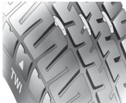
Установленной правилами минимальной глубине рисунка протектора (1,6 мм) соответствует появление индикаторов износа (TWI). Места индикаторов отмечены на боковине покрышки.
