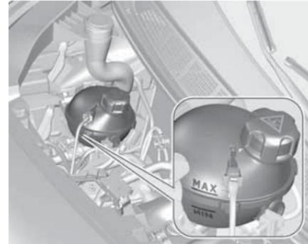
Если система охлаждения холодная, уровень охлаждающей жидкости должен быть выше метки **MIN**. Если уровень низкий, долейте охлаждающую жидкость.
