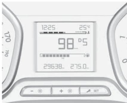
Температура охлаждающей жидкости двигателя отображается линейным индикатором из белых сегментов.
