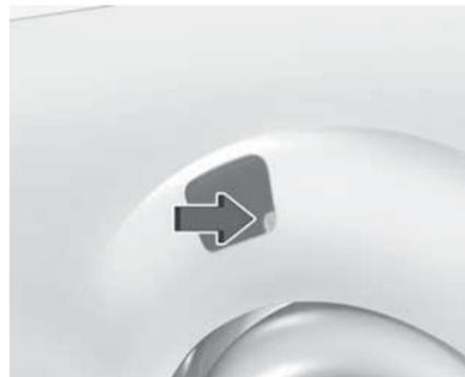
Если автомобиль оснащен системой отпирания с помощью электронного ключа, крышку люка топливного бака можно открыть только если замки дверей отперты. На некоторых модификациях для отпирания крышки люка топливного бака необходимо надавить на нее или потянуть за правый нижний угол.
