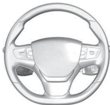
Управление круиз-контролем, адаптивным круиз-контролем и ограничителем скорости осуществляется с панели управления функциями помощи водителю на левой стороне рулевой колонки.
