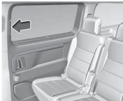
Чтобы закрыть дверь изнутри, нажмите на ручку и сдвиньте дверь вперед так, чтобы она закрылась и сработал замок.
