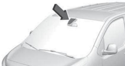
Не допускайте попадания на датчик пыли, грязи и льда.
