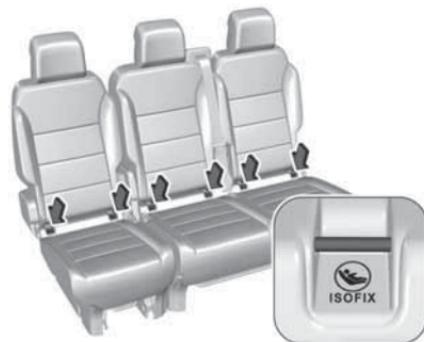
Закрепите разрешенное для применения в этом автомобиле детское удерживающее устройство с системой ISOFIX в кронштейнах ISOFIX. Разрешенные способы установки детских удерживающих устройств с креплением ISOFIX на разных сиденьях отмечены в таблице ISOFIX ⇨ 79.
