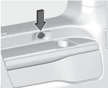
Внизу слева на средней стойке может быть установлена еще одна розетка электропитания 12 В. Максимальная потребляемая мощность не должна превышать 120 Вт.
