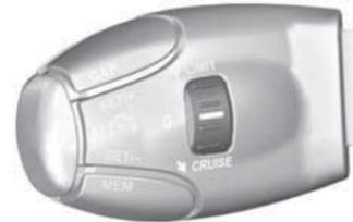
Чтобы выключить систему, поверните в положение 0. На дисплее информационного центра водителя отображается индикатор
