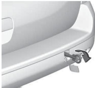
Заверните буксирную проушину до упора по часовой стрелке, остановив ее в горизонтальном положении.
