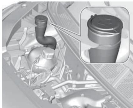
Залейте чистую воду, смешанную с соответствующим количеством разрешенной к применению содержащей антифриз промывочной жидкости.
