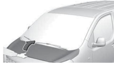
Нажмите на предохранительную защелку вверх и откройте капот.
