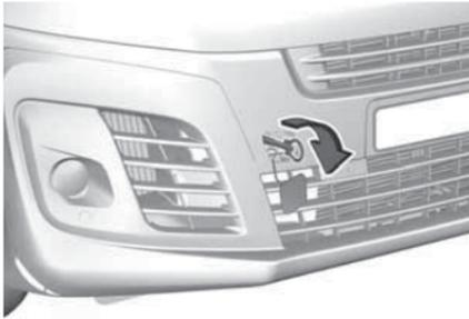
Заверните буксирную проушину до упора по часовой стрелке, остановив ее в горизонтальном положении.
