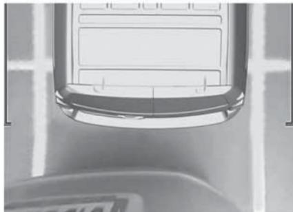
Камера записывает окружающую обстановку во время маневрирования для воссоздания вида на заднюю часть автомобиля сверху, чтобы водителю было проще объезжать расположенные поблизости препятствия. Данное представление включается в режиме **Режим AUTO** и в меню выбора вида.
