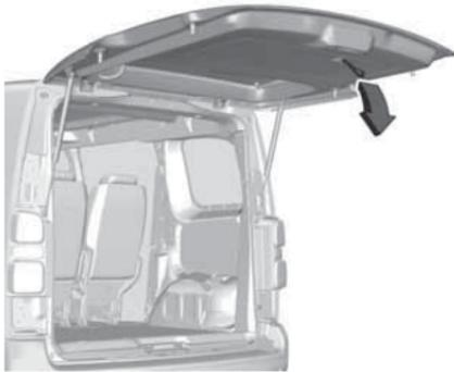
Для опускания задней подъемной двери потяните за внутреннюю ручку. Нажимая на дверь сверху, закройте ее полностью.
