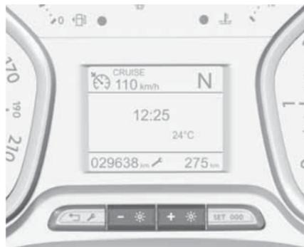
Яркость подсветки можно отрегулировать при включенном наружном освещении.
