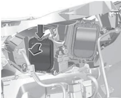
1. Снимите защитную крышку.
