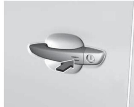
Система управления электронным ключом: При отпирании замков дверей нажатием на наружную ручку одной из передних дверей в отмеченном месте противоугонная сигнализация отключается.
