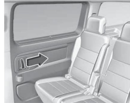
Чтобы открыть дверь изнутри, надавите на ручку и сдвиньте дверь назад, преодолевая сопротивление в конце хода.
