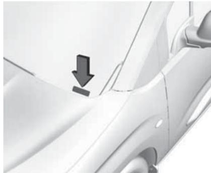
Идентификационный номер автомобиля может быть выштампован на приборной панели и виден через ветровое стекло.
