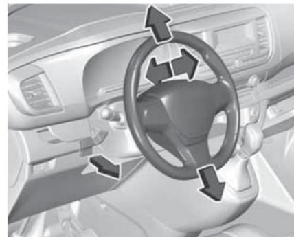
Отоприте рычаг, отрегулируйте рулевое колесо, затем зафиксируйте рычаг и убедитесь, что он полностью заблокирован. Выполняйте регулировку только на стоящем автомобиле с разблокированным рулевым колесом.
