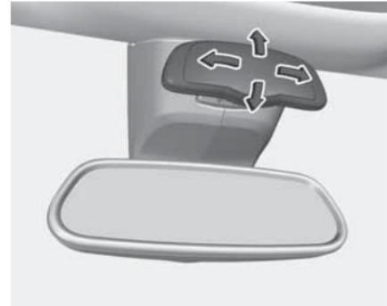
Зеркало для контроля за ребенком позволяет наблюдать за происходящим на задних сиденьях. Положение зеркала можно регулировать.
