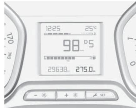
Счетчик текущего пробега имеет предельное значение 9999,9 км и не имеет автоматического сброса. Нажмите
