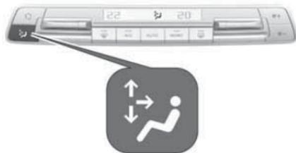
Последовательно нажимайте , пока не отобразится нужная схема распределения воздушных потоков:
