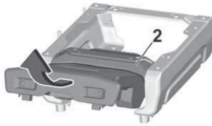
3. Приподнимите ящик, чтобы провести его мимо поперечины 2.
