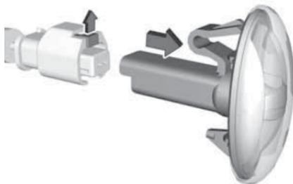
2. Оттяните фиксатор вверх и отсоедините патрон лампы от разъема.
