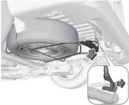
4. Поднимите держатель запасного колеса и снимите его с крюка.
