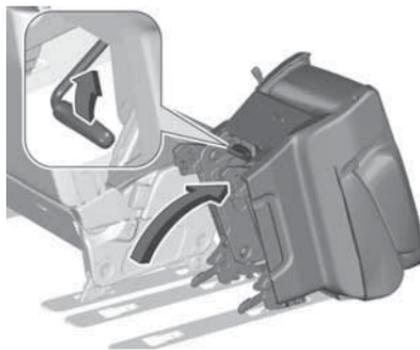
2. Потяните за рычаг освобождения фиксатора и наклоните сиденье вперед.
