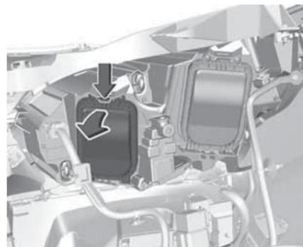
1. Снимите защитную крышку.
