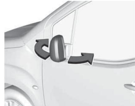
Для обеспечения безопасности пешеходов, внешние зеркала складываются от удара определенной силы. Для того чтобы вернуть зеркало в рабочее положение, нужно слегка надавить на его корпус.
