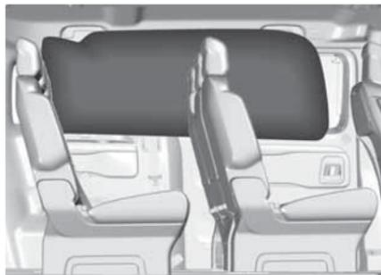
Надутые воздушные подушки безопасности амортизируют удар, тем самым они снижают опасность травмирования головы в случае серьезного бокового удара.
