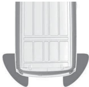
Электронный ключ должен находиться вне автомобиля на расстоянии примерно до 1 метра от датчиков движения. В зависимости от комплектации автомобиля может быть необходимо наличие электронного ключа в соответствующей зоне. Не задерживайте ногу под бампером и не двигайте слишком медленно.
