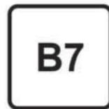
Дизельное топливо, соответствующее стандарту EN590, смешанное с биотопливом, соответствующим стандарту EN14214 (допускается содержание до 7 % метиловых эфиров жирных кислот)
