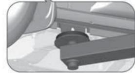
Место установки передней лапы подъемника — по центру в предусмотренном для этого месте на кузове.
