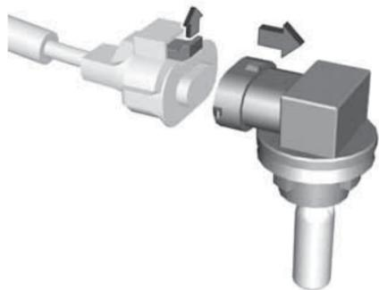
3. Отсоедините разъем, потянув за язычок фиксатора.
