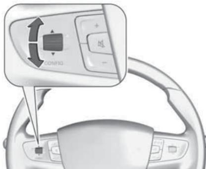
Поворачивая вверх/вниз колесико на рулевом колесе.
