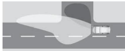
Включается на скорости до 40 км/ч при повороте. В зависимости от угла поворота рулевого колеса и от того, включен ли указатель поворота, включаются передние противотуманные фары, подсвечивая участок дороги с той стороны, в которую осуществляется поворот.
