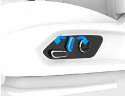
Перемещайте кнопку регулировки наклона, чтобы отрегулировать угол наклона спинки сиденья.
