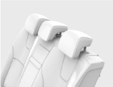
Подголовники заднего сиденья имеют функцию регулировки по высоте. Установите подголовник на такую высоту, чтобы он максимально закрывал голову.
