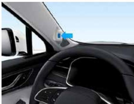
Система DMS определяет состояние водителя с помощью выделенной видеокамеры. Если система обнаруживает признаки усталости или отвлечения внимания водителя, подается звуковое предупреждение, побуждающее водителя выполнить остановку для отдыха или при невозможности этого сосредоточиться на управлении автомобилем.
