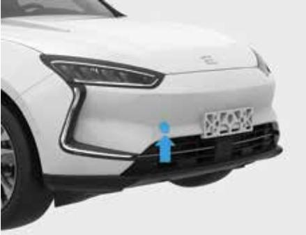
2. Используйте соответствующие инструменты, чтобы снять переднюю крышку отверстия для буксировочной проушины.
