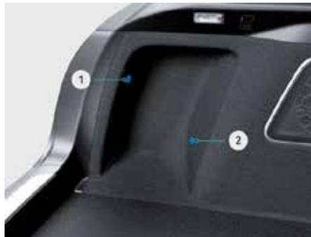
1. Трос аварийного отпирания крышки лючка зарядных розеток: используйте подходящий инструмент, чтобы ослабить защелку и потянуть за трос, чтобы открыть крышку лючка зарядных розеток.
