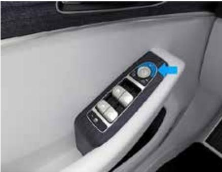
При парковке/движении в узком пространстве наружные зеркала заднего вида можно сложить. Нажмите кнопку – наружные зеркала заднего вида автоматически складываются.
