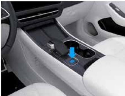
Нажмите педаль тормоза, чтобы плавно остановить автомобиль. Когда автомобиль остановился, нажмите кнопку с символом «Р», чтобы включить передачу «Р» и включить стояночный тормоз.
