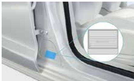
Заводская табличка автомобиля расположена на нижней части средней стойки кузова со стороны переднего пассажира.
