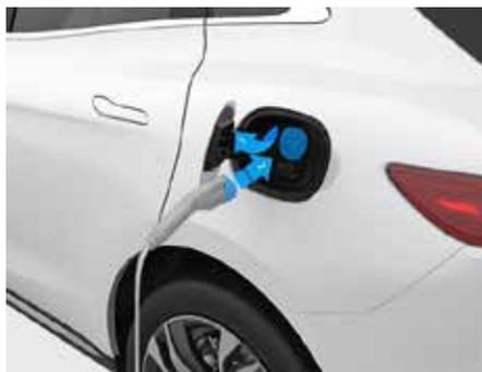
3. Снимите уплотнительную крышку ① розетки для медленной зарядки и защитную крышку ② зарядного устройства.
