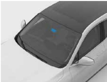
Камера видеорегистратора высокой четкости установлена в корпусе внутреннего зеркала заднего вида. Система записывает изображение, звук и параметры систем автомобиля во время движения. Эти данные могут использоваться для оказания помощи дорожной полиции при справедливом, беспристрастном и рациональном рассмотрении дорожно-транспортных происшествий и защите прав и интересов водителей во всех аспектах от нарушений.
