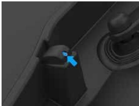
Положение форсунок омывателей стекол устанавливается на заводе-изготовителе и не нуждается в регулировке.
