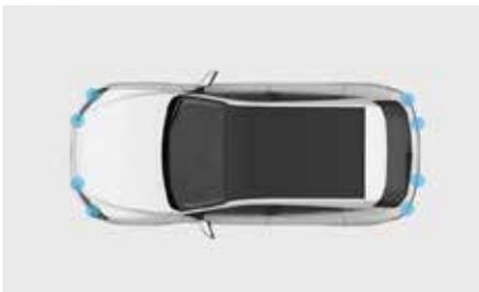
Автомобиль может быть оснащен 8 УЗ-датчиками системы помощи при парковке.
