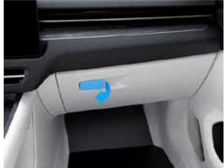
Вещевой ящик оснащен функцией охлаждения, поэтому вы можете перевозить в нем предметы, которые должны находиться в холодном состоянии.
