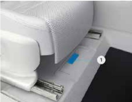
1. VIN выбит на поперечине пола под сиденьем со стороны пассажира.
