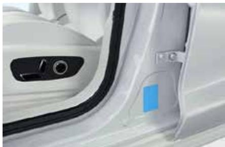
Пожалуйста, регулярно проверяйте давление воздуха в шинах, особенно перед началом дальних поездок. Накачивая шины, убедитесь, что давление достигло значения, указанного на наклейке с указанием рекомендуемого давления воздуха в шинах.
