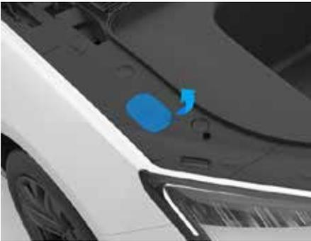
2. Откройте, приподняв вверх, заглушку крышки бачка жидкости омывателя, находящуюся в подкапотном пространстве.
