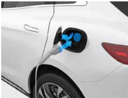
5. Снимите уплотнительную крышку ① розетки для медленной зарядки и крышку зарядного устройства ②.
