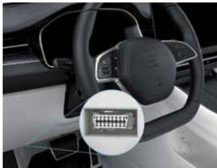
Разъем OBD специального диагностического тестера для автомобилей Evolute можно подключить к диагностическому разъему автомобиля, расположенному в нижней части передней панели. С помощью диагностического тестера можно считать VIN автомобиля.
