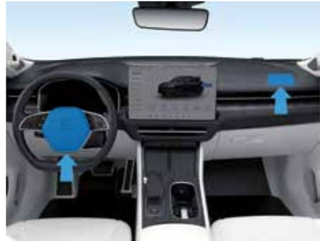
Фронтальная подушка безопасности водителя установлена в центре рулевого колеса. Фронтальная подушка безопасности переднего пассажира установлена над вещевым ящиком. На передней панели в этой зоне находится надпись «AIRBAG» (Подушка безопасности).
