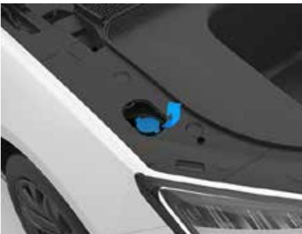
3. Откройте крышку заливной горловины бачка жидкости омывателя.
