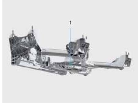
1. VIN нанесен на балке переднего подрамника.
