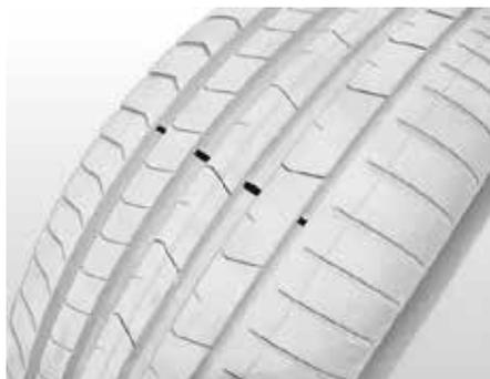
На шинах есть индикаторы износа в виде квадратных площадок, расположенных в канавках протектора. Если высота дорожки протектора стала равна высоте индикаторов износа, как можно скорее замените шину новой.
