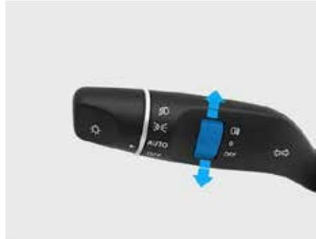
Когда включен ближний свет, поверните переключатель противотуманных фар вверх/вниз, чтобы включить/выключить задний противотуманный фонарь.
