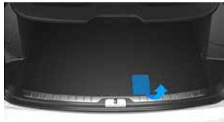
2. Снимите крышку ниши для низковольтной аккумуляторной батареи.
