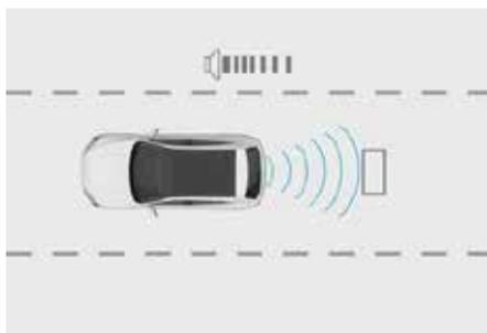
После включения передачи заднего хода автоматически включаются задние и передние УЗ-датчики.
