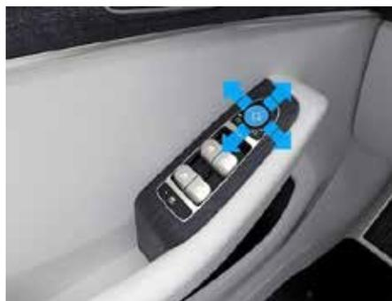
После нажатия соответствующей кнопки для выбора зеркала угол наклона зеркального элемента этого зеркала можно регулировать с помощью круглой многофункциональной кнопки.
