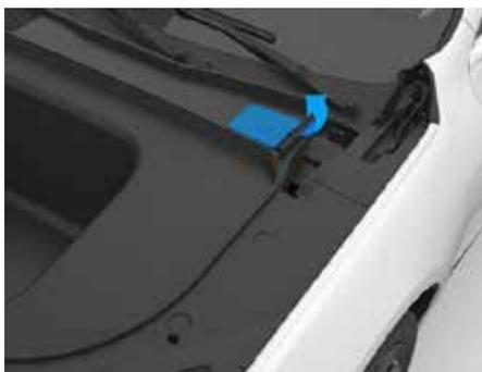
2. Откройте, подняв вверх, крышку бачка тормозной жидкости.
