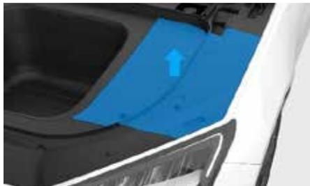
2. Левая декоративная крышка подкапотного пространства фиксируется с помощью защелки, которую необходимо поддеть посередине с левой стороны.
