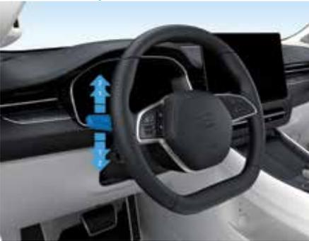
1. Плавно переместите рычаг комбинированного переключателя освещения вниз или вверх, после чего рычаг возвращается в исходное положение. При этом лампы указателя поворота и индикатор на комбинации приборов мигают 5 раз.
