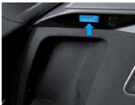
Плафон освещения багажного отсека автоматически загорается и гаснет при открывании и закрывании крышки багажного отсека.
