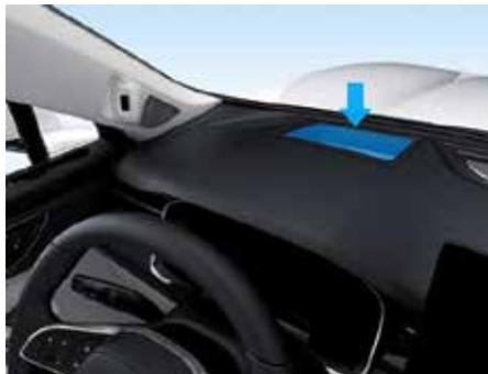
Используйте чистую и сухую салфетку из микрофибры, чтобы аккуратно протереть область расположения стекла проектора проекционного дисплея. При необходимости слегка смочите салфетку из микрофибры чистой водой.
