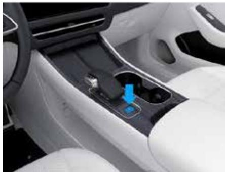
Когда автомобиль остановился, при нажатии кнопки «Р» автоматически включается стояночный тормоз, и все системы остаются работоспособными. Когда вы выйдете из автомобиля с ключом и запираете двери, бортовое питание автоматически выключается, дисплеи комбинации приборов и центрального управления гаснут.
