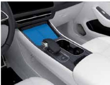
С помощью лотка для беспроводной зарядки можно заряжать мобильные телефоны.
