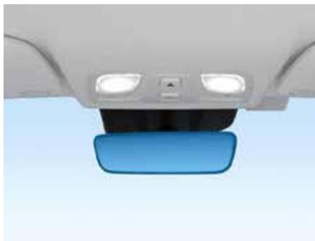
Внутреннее зеркало заднего вида, установленное в автомобиле, имеет автоматическую функцию защиты от ослепления водителя. Когда яркий свет (например, дальний свет фар автомобиля, движущегося за вашим автомобилем) попадает на внутреннее зеркало заднего вида, это зеркало автоматически затемняется, предотвращение ослепления водителя.
