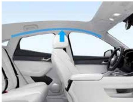
Шторки безопасности установлены под обивкой потолка с обеих сторон вдоль брусьев крыши и предназначены для защиты пассажиров (кроме пассажира среднего места заднего сиденья) при боковых столкновениях; в месте их установки нанесена надпись «AIRBAG». В случае бокового столкновения шторка безопасности раскрывается, чтобы защитить голову водителя и пассажиров от столкновения с элементами конструкции кузова автомобиля.
