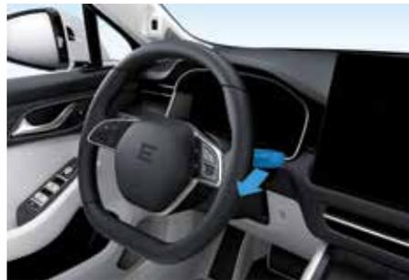
Потяните рычаг комбинированного рычага очистителя и омывателя стекол на себя – жидкость омывателя подается на ветровое стекло, и несколько раз срабатывает очиститель этого стекла.
