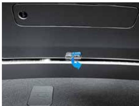
3. Поверните аварийный выключатель крышки багажного отсека вправо.
