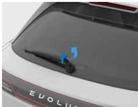
2. С помощью подходящего инструмента снимите декоративную крышку гайки крепления щетки очистителя заднего стекла.
