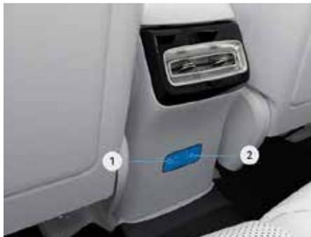
В задней части напольной консоли есть две розетки для зарядки мобильных устройств.
