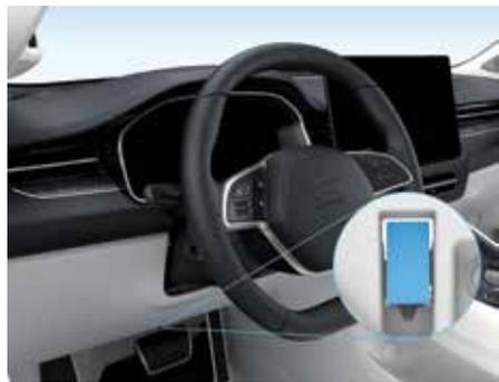
Дважды потяните рукоятку в нижней части передней панели со стороны водителя, чтобы открыть капот. Он открывается автоматически и поднимается на определенную высоту. Кроме того, капот можно открыть вручную.
