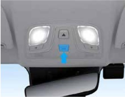
Откройте защитную крышку выключателя («SOS»), затем нажмите кнопку «SOS», чтобы вручную активировать функцию вызова экстренных служб. Информация о состоянии автомобиля (местоположение, время, данные о неисправностях и т. д.) автоматически отправляется в центр экстренных служб, а на центральном дисплее управления отображается экран вызова. Центр экстренного вызова должен своевременно предоставлять услуги на основе информации о состоянии, поступившей из автомобиля, и ситуации с вызовом.
