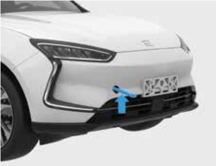
3. Вверните буксировочную проушину по часовой стрелке и затяните ее.
