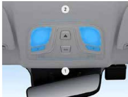
Передние лампы для чтения расположены на потолочной консоли. Нажмите кнопку, чтобы включить или выключить лампу для чтения.
