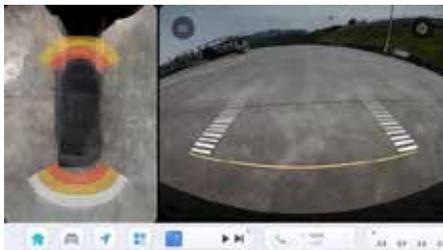
Выделенная область в форме сектора указывает на то, что в этой области был обнаружен объект. По мере приближения автомобиля к объекту цвет выделенной области в форме веера изменяется с желтого на красный. Подается звуковое предупреждение, и чем ближе автомобиль находится к объекту, тем выше частота звукового предупреждения.
