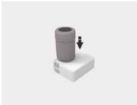
4. Достаньте инструменты для ремонта шин, вставьте баллон с герметиком для ремонта шин в углубление компрессора и сильно нажмите.
