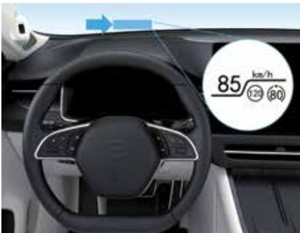
Проекционный дисплей позволяет отображать некоторые данные комбинации приборов, в том числе навигационные, на ветровом стекле перед водителем.
