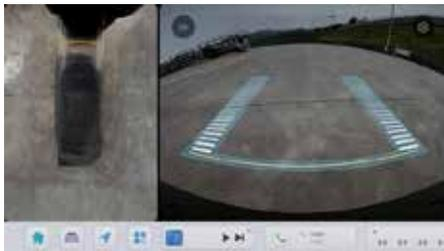
После включения системы кругового обзора на центральном дисплее управления отображаются линии колеи колес.
