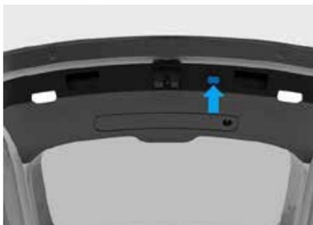
Нажмите кнопку закрывания крышки багажного отсека чтобы закрыть ее.
