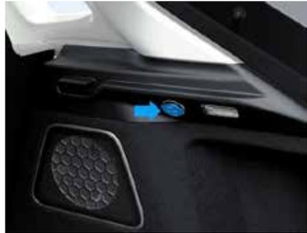
К этой розетке можно подключать такое оборудование, как автомобильные холодильник и компрессор для накачки шин.
