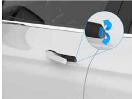
2. Нажмите на задний конец наружной ручки двери водителя, чтобы выдвинуть ее.
