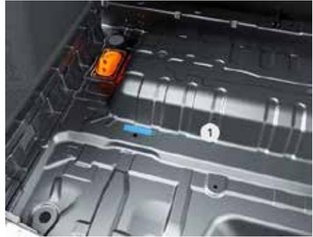
1. VIN нанесен с левой стороны багажного отсека под фальшполом.
