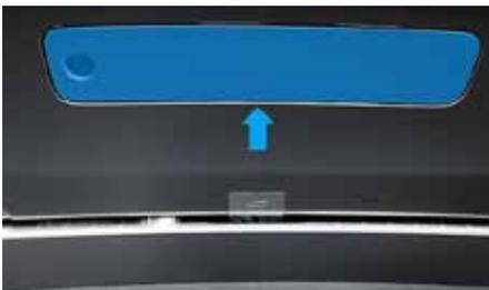
Расположен в двери багажного отсека. Поверните ручку, чтобы снять крышку и извлеките знак аварийной остановки.
