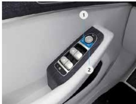
Вы можете использовать переключатель регулировки наружных зеркал заднего вида, расположенный на двери водителя, для регулировки положения этих зеркал.
