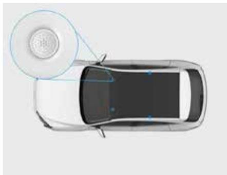
Функция голосового управления реализуется с помощью 4 микрофонов, расположенных на обивке потолка.
