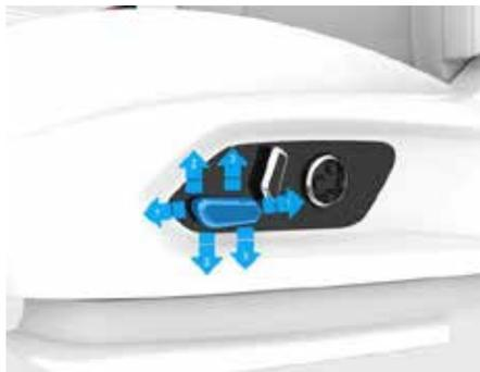
1. Нажмите кнопку регулировки высоты передней/задней части подушки сиденья и установите подушку сиденья в наиболее удобное положение.
