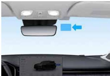
Это окно используется для установки электронного идентификатора автомобиля. Электронный идентификатор должен быть обращен к передней части автомобиля и приклеен с внутренней стороны ветрового стекла.
