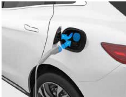
3. Снимите уплотнительную крышку ① розетки для медленной зарядки и снимите защитную крышку ②.
