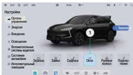
**1. Управление стеклоподъемниками:** нажмите, чтобы получить доступ к настройкам управления стеклоподъемниками. Здесь можно выбрать варианты «Полностью открыть», «Режим вентиляции» или «Полностью закрыть».
