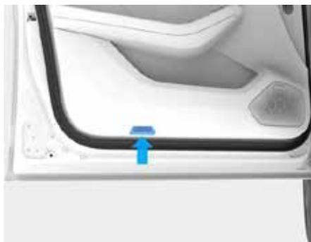
Этот фонарь расположен в нижней части каждой двери. Он автоматически загорается или гаснет при открывании или закрывании соответствующей двери.
