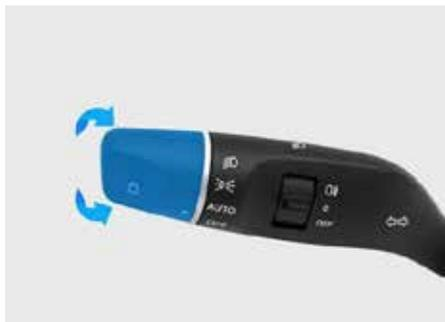
Поверните ручку комбинированного переключателя освещения, чтобы выбрать режим габаритного света и дальнего света фар.
