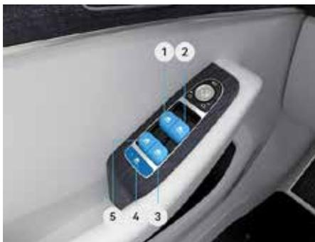
Вы можете использовать переключатель стеклоподъемника на двери водителя для приведения в действие стеклоподъемников с электроприводом всех дверей. Пассажиры могут использовать переключатели стеклоподъемников на ближайших к ним дверях.
