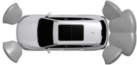
С шестью ультразвуковыми датчиками
