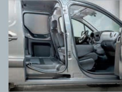
За счет складывающегося сиденья полезный объем может быть увеличен до 3,7 м<sup>3</sup>, что позволит перевозить грузы длиной до 3 м в версии с кузовом стандартной длины. Вместимость версии с удлиненным кузовом может быть увеличена до 4,1 м<sup>3</sup> с перевозимым грузом длиной до 3,25 м. Грузоподъемность фургона – до 732 килограммов.
