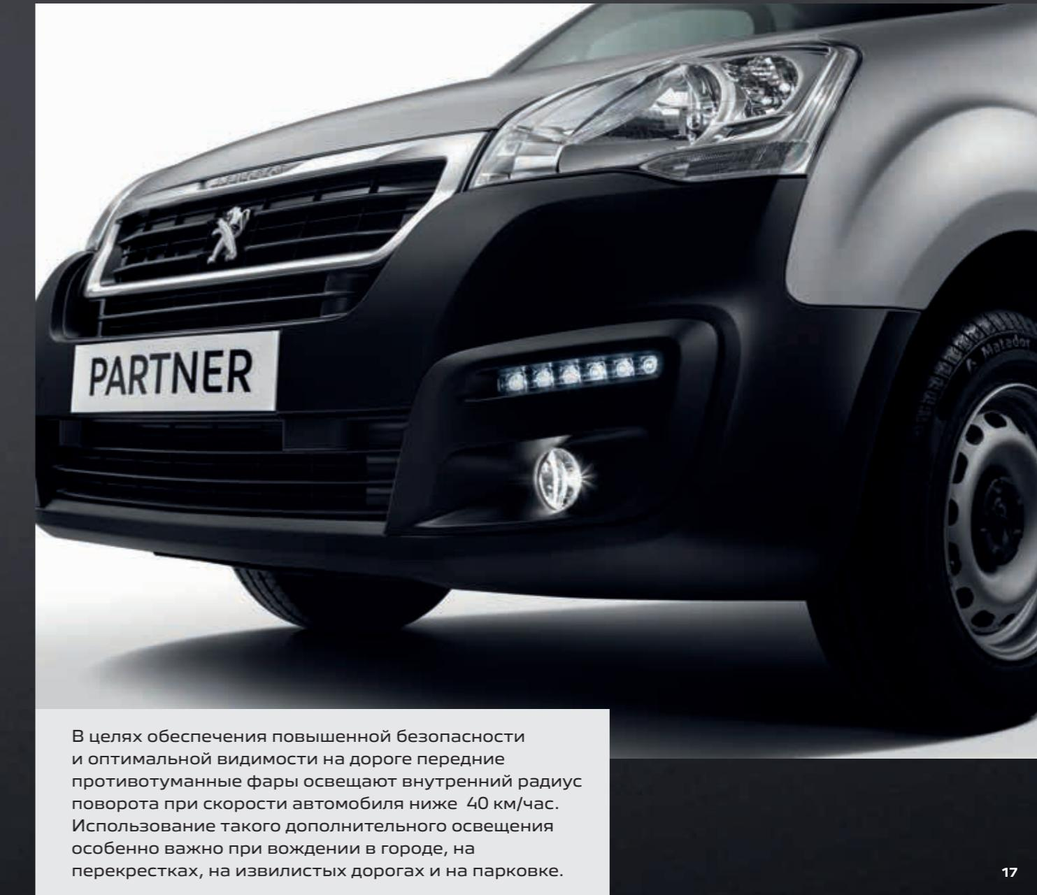
В целях обеспечения повышенной безопасности и оптимальной видимости на дороге передние противотуманные фары освещают внутренний радиус поворота при скорости автомобиля ниже 40 км/час. Использование такого дополнительного освещения особенно важно при вождении в городе, на перекрестках, на извилистых дорогах и на парковке.
