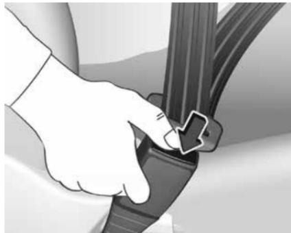
Для того чтобы снять ремень, нажмите красную кнопку на его замке.
