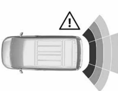
Кроме того, расстояние до находящегося сзади препятствия отображается на дисплее информационного центра водителя  $\diamond 135$  с помощью цветных сегментов. Когда расстояние до препятствия становится опасным, появляется значок  $\Delta$ .
