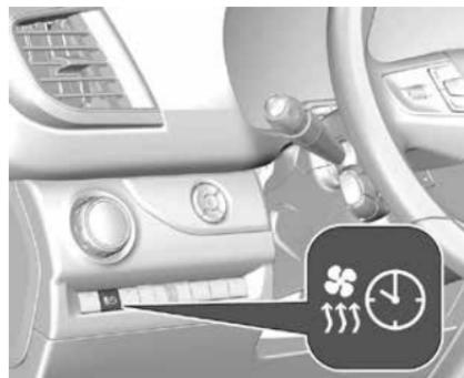
Текущее состояние автономного отопителя указывается светодиодным индикатором.
