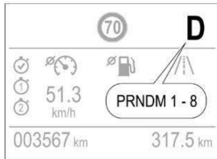
На дисплей информационного центра водителя выводится режим работы и выбранная передача.
