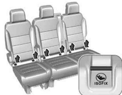
Закрепите разрешенное для применения в этом автомобиле детское удерживающее устройство с системой ISOFIX в кронштейнах ISOFIX. Разрешенные способы установки детских удерживающих устройств с креплением ISOFIX на разных сиденьях отмечены в таблице ISOFIX  $\diamond$  79.
