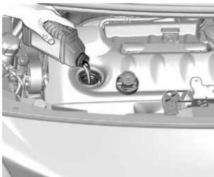
Если уровень моторного масла упал до отметки **MIN**, необходимо долить моторное масло.
