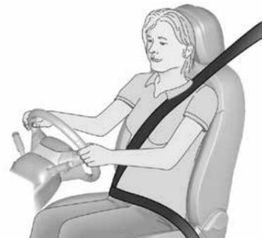
Вытяните ремень безопасности и застегните пряжку. Ремень безопасности не должен быть перекручен и должен плотно прилегать к телу. Спинку сиденья не следует слишком сильно наклонять назад (максимальный угол отклонения примерно 25°).
