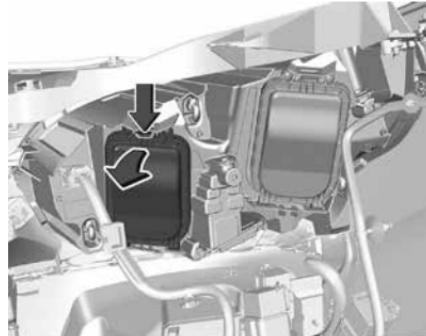
1. Снимите защитную крышку.
