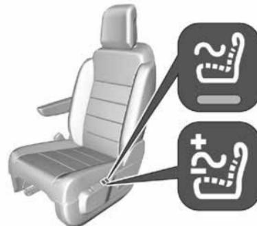
Функция массажа спины включается нажатием . В кнопке загорается светодиод, указывая, что система работает.
