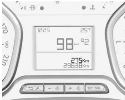
Счетчик текущего пробега имеет предельное значение 9999,9 км и не имеет автоматического сброса. Нажмите **SET 000** и удерживайте 2 секунды, чтобы сбросить показания счетчика текущего пробега.
