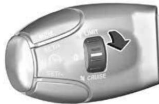
Поверните переключатель в положение **Cruise**; на дисплее информационного центра водителя отобразится индикатор
