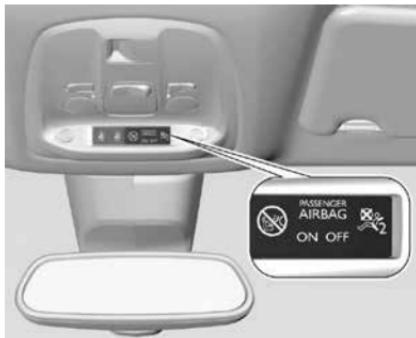
Если индикатор горит после выключения зажигания примерно 60 секунд, система надувных подушек безопасности переднего пассажира сработает в случае столкновения.
