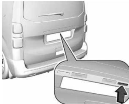
Если электронный ключ находится снаружи автомобиля, но не далее примерно 1 метра от подъемной задней двери, нажмите правую кнопку на подъемной задней двери грузового отделения, чтобы отпрыть замки.
