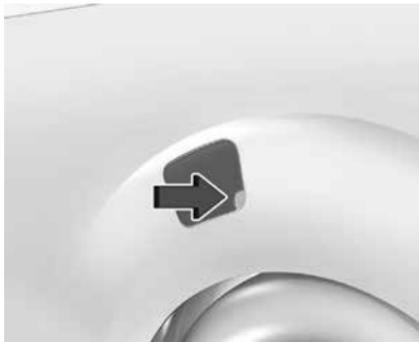
Если автомобиль оснащен системой отпирания с помощью электронного ключа, крышку люка топливного бака можно открыть только если замки дверей открыты. На некоторых модификациях для отпирания крышки люка топливного бака необходимо надавить на нее или потянуть за правый нижний угол.
