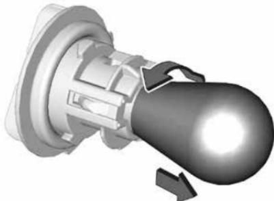
3. Слегка прижмите лампу, поверните ее против часовой стрелки и извлеките из гнезда.
