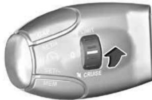
Поверните переключатель в положение **Limit**; на дисплее информационного центра водителя отобразится индикатор и появится сообщение. Система остается неактивной.
