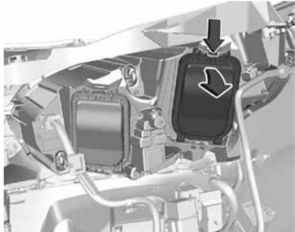
1. Снимите защитную крышку.
