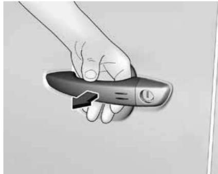
Возьмитесь за ручку одной из передних дверей, сдвижных дверей или задних распашных дверей либо нажмите кнопку на задней подъемной двери.
