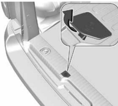
2. Снимите крышку несущего болта, расположенную в пороге задней двери
