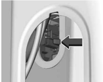
4. Придерживая блок фонаря, отожмите фиксатор, удерживающий блок фонаря в кузове.
