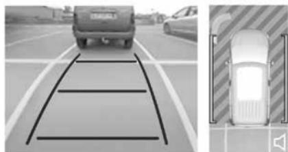
Информационный дисплей делится на две части. Справа отображается вид на автомобиль сверху, а слева — изображение с задней камеры. Датчики парковки дополняют визуальную информацию (вид на автомобиль сверху), получаемую от камеры.
