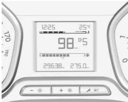
Температура охлаждающей жидкости двигателя отображается линейным индикатором из белых сегментов.
