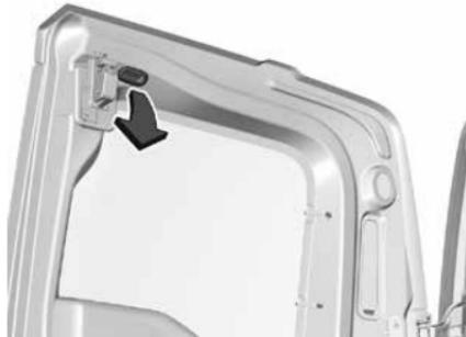
Оберните плоское жало отвертки тряпкой, чтобы не повредить лакокрасочное покрытие. Снимите внутреннюю крышку или вентиляционную решетку с помощью отвертки.
