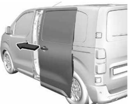
Чтобы закрыть дверь снаружи, потяните ручку и сдвиньте дверь вперед до тех пор, пока она не закроется и не сработает замок.
