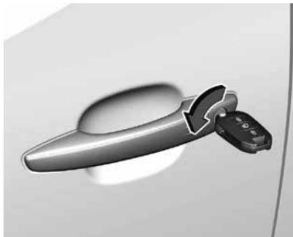
Отоприте дверь водителя вручную, вставив ключ в замок и повернув его.
