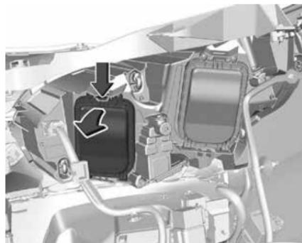
1. Снимите защитную крышку.
