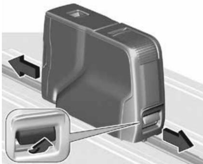
Чтобы переместить многофункциональный столик, потяните за рукоятку спереди, не преодолевая точку сопротивления. Сдвиньте многофункциональный столик вперед или назад. Установив его в желаемое положение, отпустите рукоятку. Проследите, чтобы многофункциональный столик был надежно зафиксирован.
