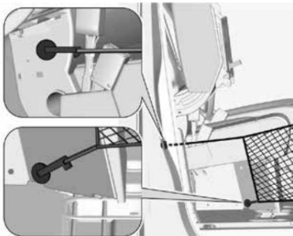
3. Вставьте крепление в отверстие. Чтобы зафиксировать крепление, поверните его на четверть оборота по часовой стрелке.
