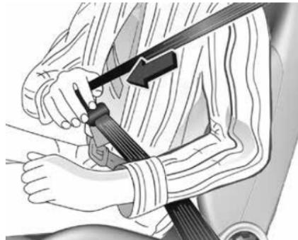
Вытянуть ремень безопасности из подматывающего механизма, не перекручивая направить его попере<sup>к</sup> туловища и вставить язычок защелки ремня безопасности в пряжку. Во время движения автомобиля следует регулярно подтягивать поясную часть ремня, вытягивая ремень за плечевую часть.
