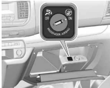
Фронтальная подушка безопасности переднего пассажира отключается с помощью выключателя, расположенного на панели приборов со стороны пассажира.
