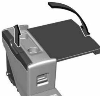
С двух сторон расположены панели. Вытяните панель вверх до упора и расположите ее горизонтально.
