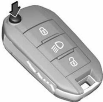
Для раскрытия нажмите на кнопку. При складывании ключа, сначала нажмите кнопку.
