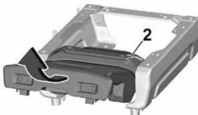
3. Приподнимите ящик, чтобы провести его мимо поперечины 2.
