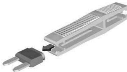
Захватите предохранитель с помощью приспособления и вытащите предохранитель.
