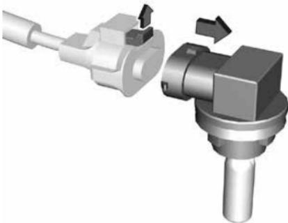
3. Отсоедините разъем, потянув за язычок фиксатора.
