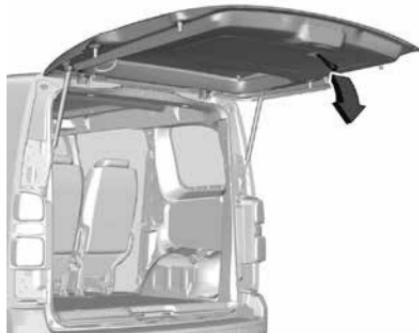
Для опускания задней подъемной двери потяните за внутреннюю ручку. Нажимая на дверь сверху, закройте ее полностью.
