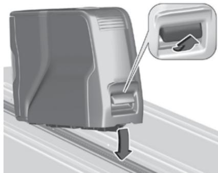
Рукоятка спереди должна быть в зафиксированном положении. Установите заднюю часть многофункционального столика на направляющую и опустите переднюю часть. Сдвиньте многофункциональный столик до фиксации.
