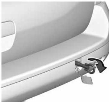
Заверните буксирную проушину до упора по часовой стрелке, остановив ее в горизонтальном положении.
