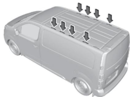
Установите на крышу багажник, используя крепежные точки, отмеченные на иллюстрации.
