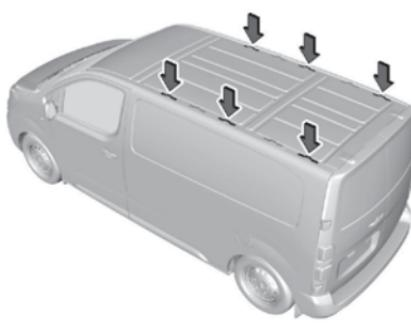
Установите на крышу три рейлинга, используя крепежные точки, отмеченные на иллюстрации.
