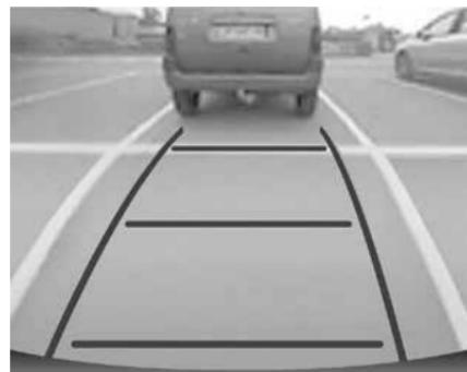
На дисплее отображается пространство позади автомобиля. Расстояние между боковыми линиями направляющей разметки соответствует ширине автомобиля
