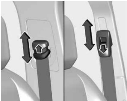
Нажмите на кнопку фиксатора и переместите регулятор высоты вверх или вниз в нужное положение.
