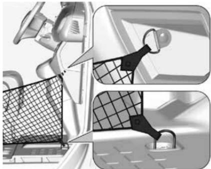
4. Зацепите крючки за крепежные проушины в перчаточном ящике и на полу.
