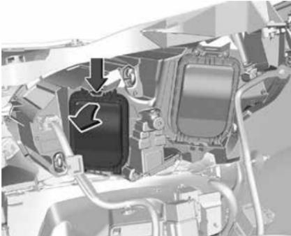
1. Снимите защитную крышку.
