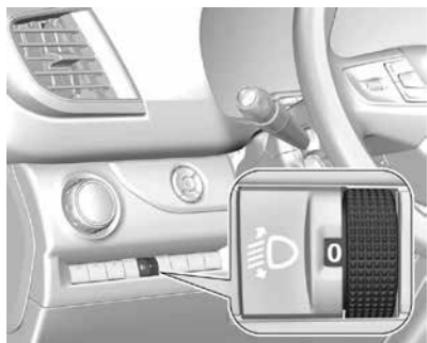
Чтобы подстроить наклон света фар в соответствии с загрузкой автомобиля во избежание ослепления встречных водителей: поверните колесико с накаткой ⚡ в требуемое положение.
