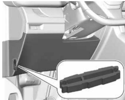
Отсоедините фиксаторы крышки, потянув сначала вверх слева, затем справа. Полностью снимите крышку и переверните ее.
