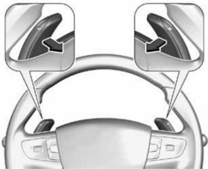
2. Используйте подрулевые лепестки для ручного переключения передач.
