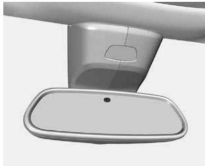
При движении в темное время суток автоматически снижается ослепление водителя светом фар движущегося сзади транспорта.
