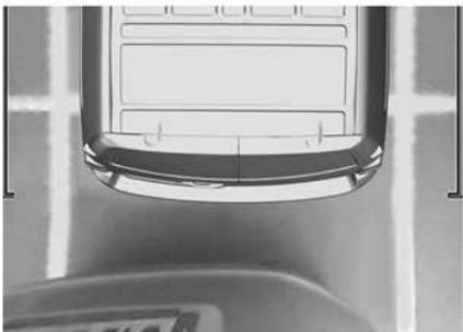
Камера записывает окружающую обстановку во время маневрирования для воссоздания вида на заднюю часть автомобиля сверху, чтобы водителю было проще объезжать расположенные поблизости препятствия. Данное представление включается в режиме **Режим AUTO** и в меню выбора вида.
