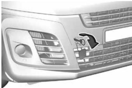
Заверните буксирующую проушину до упора по часовой стрелке, остановив ее в горизонтальном положении.
