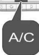
Нажмите клавишу **A/C**, чтобы включить режим охлаждения. В кнопке загорается светодиод, указывая, что система работает. Охлаждение работает только при включенном двигателе и вентиляторе.
