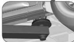
Место установки задней лапы подъемника — по центру в предусмотренном для этого месте на кузове.
