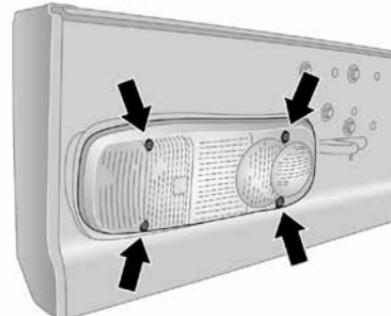
1. Выкрутите четыре винта крепления рассеивателя.
