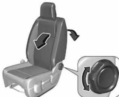
Регулировка угла наклона спинки сиденья осуществляется вращением рукоятки. Во время регулировки не облокачивайтесь на спинку.
