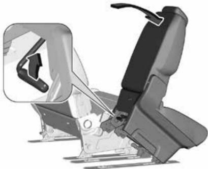
Потяните за рычаг освобождения фиксатора и наклоните сиденье вперед.
