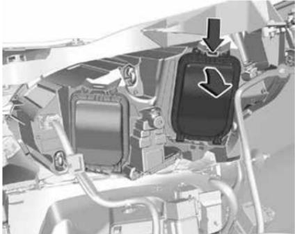
1. Снимите защитную крышку.
