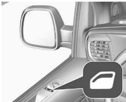
Потяните или нажмите клавишу
