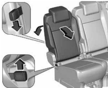
Потяните за передний рычаг или нажмите на задний рычаг, чтобы освободить и отрегулировать спинку сиденья.
