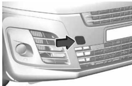
Чтобы отсоединить крышку, нажмите на середину панели и сдвиньте в сторону верхнего левого угла.
