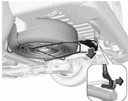
4. Поднимите держатель запасного колеса и снимите его с крюка.
