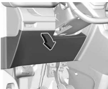
Снимите крышку, потянув за верхний край сначала слева, затем справа.
