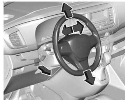
Отоприте рычаг, отрегулируйте рулевое колесо, затем зафиксируйте рычаг и убедитесь, что он полностью заблокирован. Выполните регулировку только на стоящем автомобиле с разблокированным рулевым колесом.
