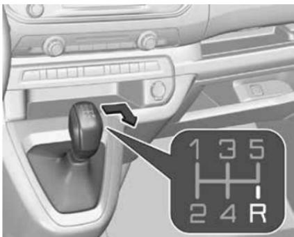
Для включения передачи заднего хода на автомобиле с 5-ступенчатой коробкой передач выжмите педаль сцепления и сместите рычаг вправо и назад.
