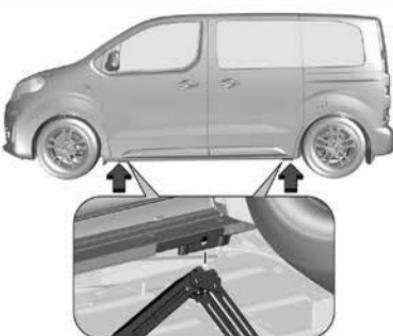
3. Убедитесь, что домкрат надлежащим образом установлен под соответствующей подъемной точкой на автомобиле. Поставить его непосредственно под точкой для поддомкрачивания так, чтобы он не высокользнул.
