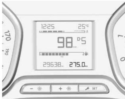
Счетчик текущего пробега имеет предельное значение 9999,9 км и не имеет автоматического сброса.
