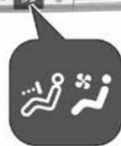
Чтобы включить подачу охлажденного/теплого воздуха через задние сопла вентиляции, нажмите .
