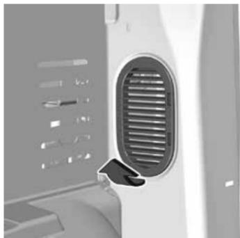
3. Автомобили с вентиляционной решеткой или крышкой за задним фонарем в декоративной панели: Снимите вентиляционную решетку или крышку.
