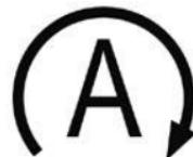
Если автомобиль движется с низкой скоростью или стоит на месте и при этом выполняются определенные условия, срабатывает функция автоматической остановки двигателя.
