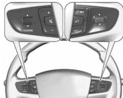
Меню и функции информационного центра водителя можно выбирать при помощи поворотной ручки на левом подрулевом переключателе.
