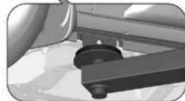
Место установки передней лапы подъемника — по центру в предусмотренном для этого места на кузове.
