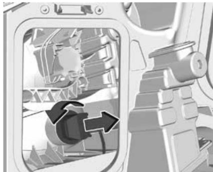
2. Поверните разъем лампы против часовой стрелки, чтобы высвободить и вынуть его из рефлектора.
