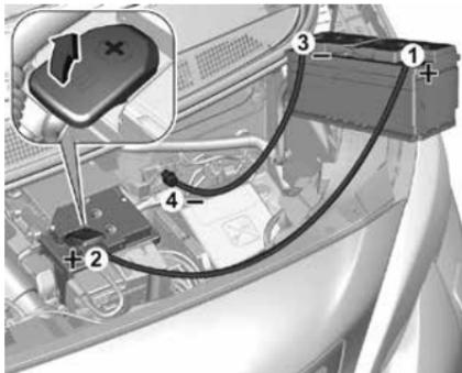
Снимите защитные колпачки с положительных клемм обеих аккумуляторных батарей.
