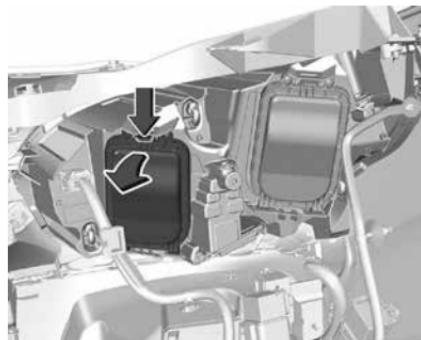
1. Снимите защитную крышку.
