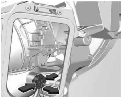
2. Нажмите на фиксаторы патрона лампы, чтобы отсоединить патрон, и вытащите его из отражателя.
