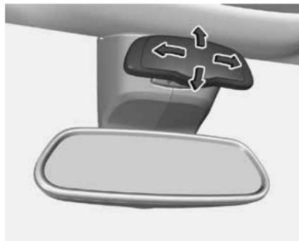
Зеркало для контроля за ребенком позволяет наблюдать за происходящим на задних сиденьях. Положение зеркала можно регулировать.
