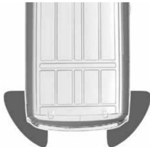
Электронный ключ должен находиться вне автомобиля на расстоянии примерно до 1 метра от датчиков движения. В зависимости от комплектации автомобиля может быть необходимо наличие электронного ключа в соответствующей зоне. Не задерживайте ногу под бампером и не двигайтесь слишком медленно.
