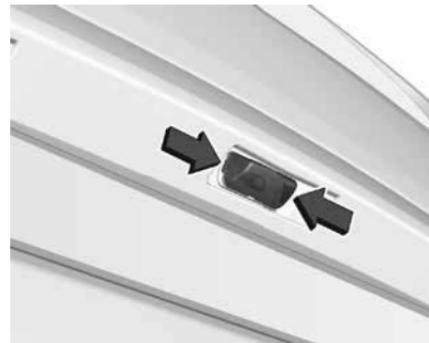
Вставьте, например, тонкую отвертку в один из вырезов крышки и нажмите на нее наружу, чтобы отсоединить крышку. Снимите крышку.
