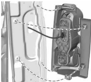
5. Снимите задний фонарь в сборе, аккуратно вынув его из ниши. Следите за тем, чтобы жгут проводов оставался на своем месте.
