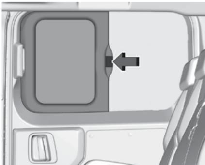
Для открывания и закрывания задних окон нажмите на рычаг и сдвиньте окно назад или вперед.
