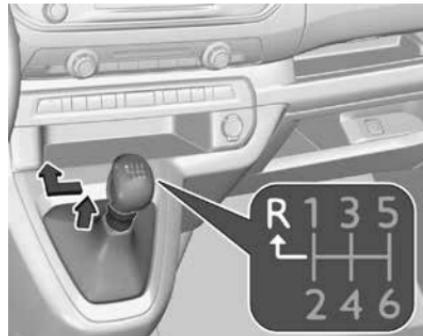
Для включения передачи заднего хода на автомобиле с 6-ступенчатой коробкой передач выжмите педаль сцепления, потяните вверх кольцо на рычаге и сместите рычаг до конца влево и вперед.
