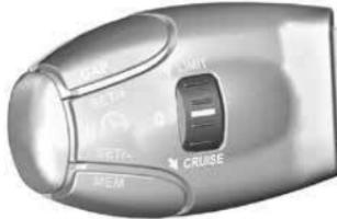
Чтобы выключить систему, поверните в положение 0. На дисплее информационного центра водителя отображается индикатор
