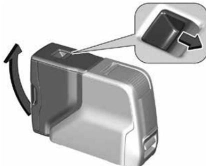
Чтобы разложить многофункциональный столик, потяните за рукоятку вверху. Потяните за заднюю часть вертикально до фиксации.
