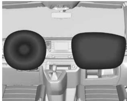
Надутые воздушные подушки безопасности амортизируют удар, тем самым они снижают опасность значительного травмирования верхней части туловища и головы переднего пассажира и водителя.
