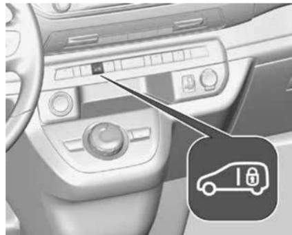
На некоторых модификациях замок подъемной задней двери грузового отделения можно отпереть изнутри, нажав кнопку
