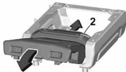
1. Вставьте ящик, держа его наклонно передней стороной вверху. Проведите ящик мимо поперечины 2, нажимая на него внутрь и вниз.
