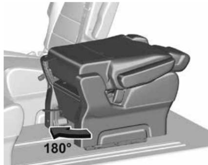
3. Немного поднимите и поверните сиденье на 180° до фиксации.
