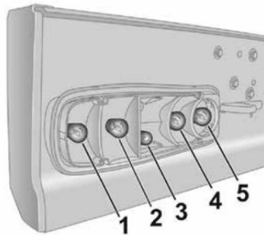
3. Слегка прижмите лампу в патрон, поверните против часовой стрелки, извлеките и замените лампу.
