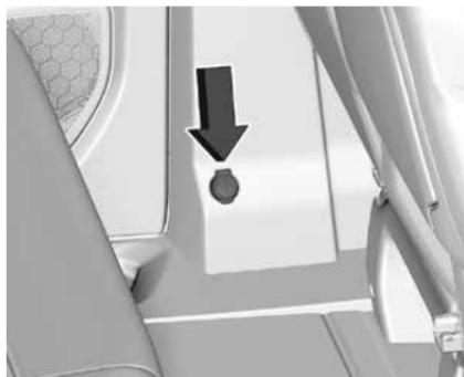
Внизу слева на средней стойке может быть установлена розетка электропитания 12 В.
