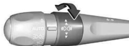
Для включения/выключения передних противотуманных фар поверните колесико управления один раз.
