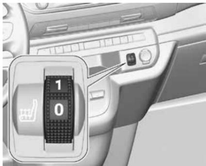
Подогрев сидений включается колесиком на соответствующем переднем сиденье. Подогрев имеет три уровня интенсивности.
