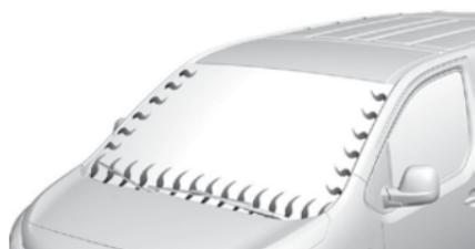
Эта функция обеспечивает подогрев ветрового стекла снизу и сбоку с обеих сторон.
