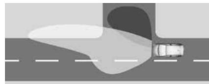
Включается на скорости до 40 км/ч при повороте. В зависимости от угла поворота рулевого колеса и от того, включен ли указатель поворота, включаются передние противотуманные фары, подсвечивая участок дороги с той стороны, в которую осуществляется поворот. Включить или отключить эту функцию можно в меню сохранения индивидуальных настроек ⇨ 140.
