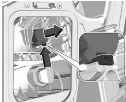
2. Нажмите на фиксатор и выньте патрон лампы из корпуса отражателя.
