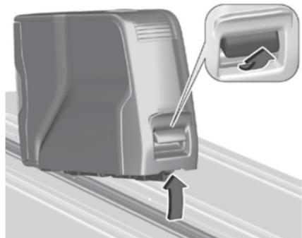
Чтобы демонтировать многофункциональный столик, потяните за рукоятку спереди дальше точки сопротивления. Снятие многофункционального столика.
