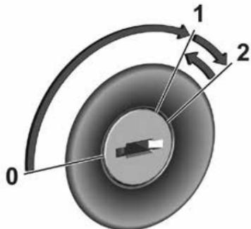
Для разблокировки рулевого колеса поверните ключ в положение 1.
