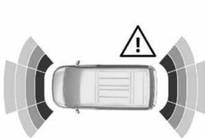
Кроме того, расстояние до находящегося сзади или спереди препятствия отображается на дисплее информационного центра водителя  $\diamond 135$  с помощью цветных сегментов.
