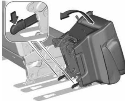
2. Нажмите на рычаги, чтобы зафиксировать передние крепления, и наклоните сиденье назад до фиксации.
