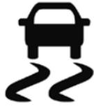
После пуска двигателя системы контроля тягового усилия и динамической стабилизации будут готовы к работе, как только погаснет индикатор
