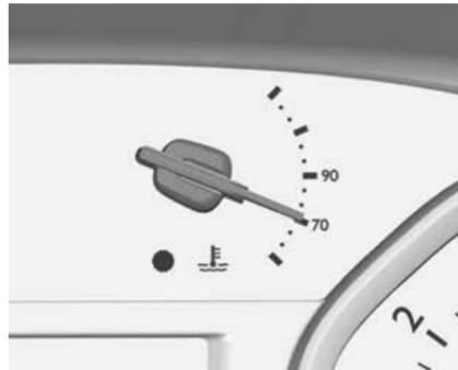
70 °C : рабочая температура двигателя еще не достигнута
