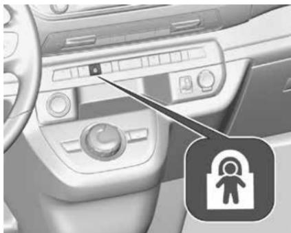
Дистанционно управляемая система, предотвращающая открывание сдвижных дверей дверными ручками в салоне.
