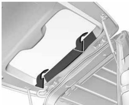
Снимите внутреннее обрамление с фиксаторов, наклонив его вверх и вниз. Аккуратно выньте обрамление.
