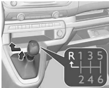
Для включения передачи заднего хода на автомобиле с 6-ступенчатой коробкой передач выжмите педаль сцепления, потяните вверх кольцо на рычаге и сместите рычаг до конца влево и вперед.
