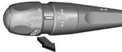
Чтобы включить подсветку дорожки вручную, выключите зажигание, откройте дверь водителя и потяните за рычажок управления световыми приборами.
