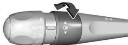
Для включения/выключения заднего противотуманного фонаря поверните колесико управления один раз.
