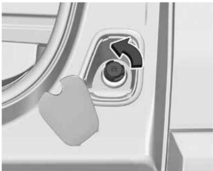
4. Скрутите предохранительную пробку с заправочной горловины.
