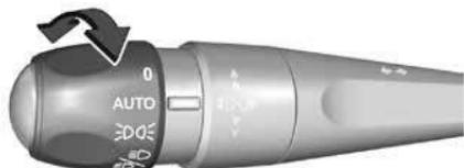
При включенном автоматическом управлении освещением и работающем двигателе осуществляется автоматический переход между режимами дневных ходовых огней и штатным режимом работы
