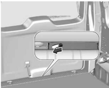
Через технологическое отверстие между дверью и полом с помощью специального инструмента можно отпереть замок подъемной задней двери грузового отделения. Прижмите рычаг влево, чтобы отпереть и открыть подъемную заднюю дверь.
