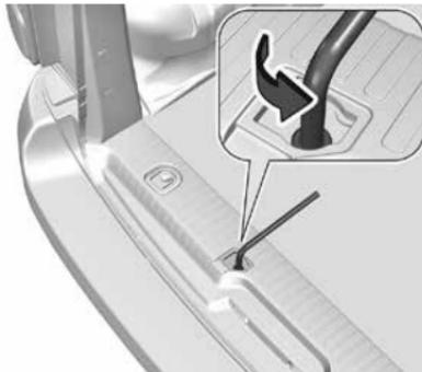
3. Установите баллонный ключ на болт с шестигранной головкой. Вращайте его против часовой стрелки, пока держатель запасного колеса не опустится настолько, чтобы его можно было снять с крюка.
