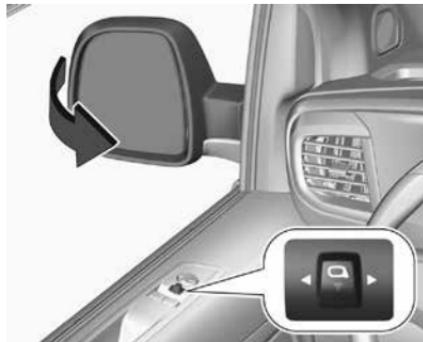
Потяните клавишу складывания наружных зеркал . При этом оба наружных зеркала складываются.
