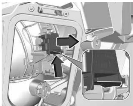
2. Нажмите на фиксатор и выньте патрон лампы из корпуса отражателя.
