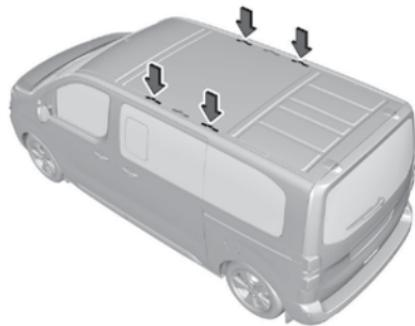
Установите на крышу два рейлинга, используя крепежные точки, отмеченные на иллюстрации.
