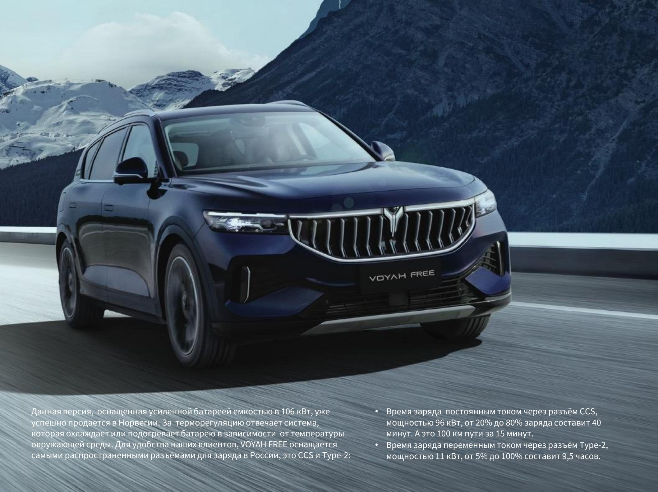
Данная версия, оснащенная усиленной батареей емкостью в 106 кВт, уже успешно продается в Норвегии. За терморегуляцию отвечает система, которая охлаждает или подогревает батарею в зависимости от температуры окружающей среды. Для удобства наших клиентов, VOYAH FREE оснащается самыми распространенными разъемами для заряда в России, это CCS и Type-2:
